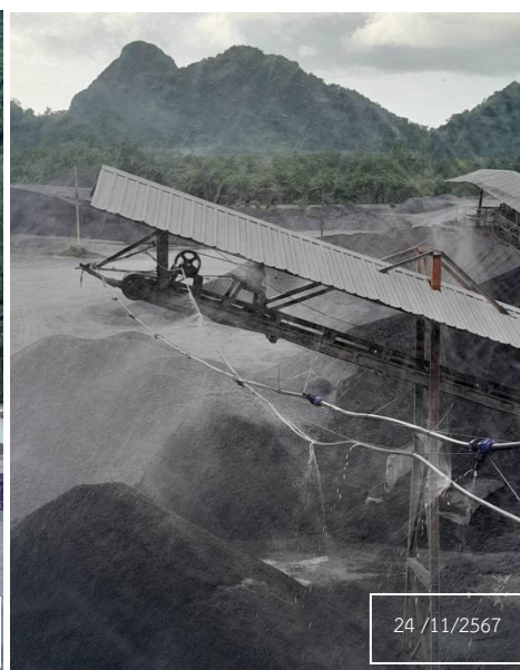
ภาพที่ 9 ระบบสเปรย์น้ำบริเวณปลายสายพานลำเลียงและมีระบบปิดคลุม
